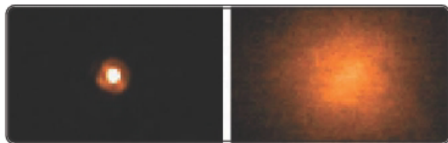
上図=188素子補償光学系とレーザーガイド星生成システムの原理と構成概要 右写真=188素子補償光学オン時とオフ時の星像。揺らぎを補正しシャープな画像を得た(いずれも国立天文台提供)
